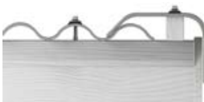
40. att. Vējmalas ar liektu malu montāža.
