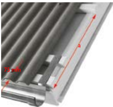
2. att. Pie jumta karnīzes attālums no loksnes EUROFALA šķautnes līdz pirmajam stiprinājumam ir vismaz 75 mm.
