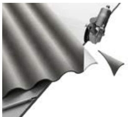
14. att. Viens no lokšņu stūru griešanas piemēriem. Griešana veikta ar leņķa slīpmašīnu, kam uzlikts segmentēts betona griešanas disks.
