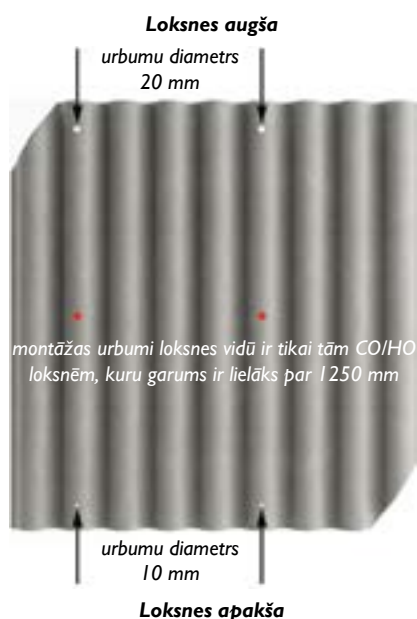
22. att. Lokсне „EuroFala B59 CO/HO” – nogriezti stūri un montāžas urbumi. Loksnēm „EuroFala B65 CO/HO” montāžas urbumi izurbti 2. un 5. viļņa virsotnē.
