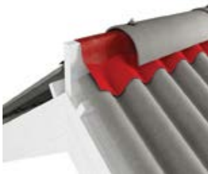
7. att. Kore klāta ar pusapaljiem noslēdzošajiem elementiem un kores joslu – ventilācijas virsma 1 kores tm: lokšnes B59 – 150 cm 2 , lokšnes B65 – 255 cm 2 katrai jumta slīpei.
