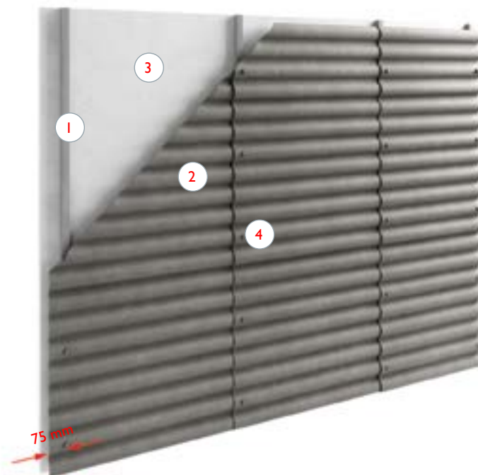
52. att. Horizontāla lokšņu montāža uz fasādēm / sienām, pārslaidot vienu vilni pār otru sienas garumā un vertikāli pārslaidot lokšņu galus vienu pār otru 150 mm.
